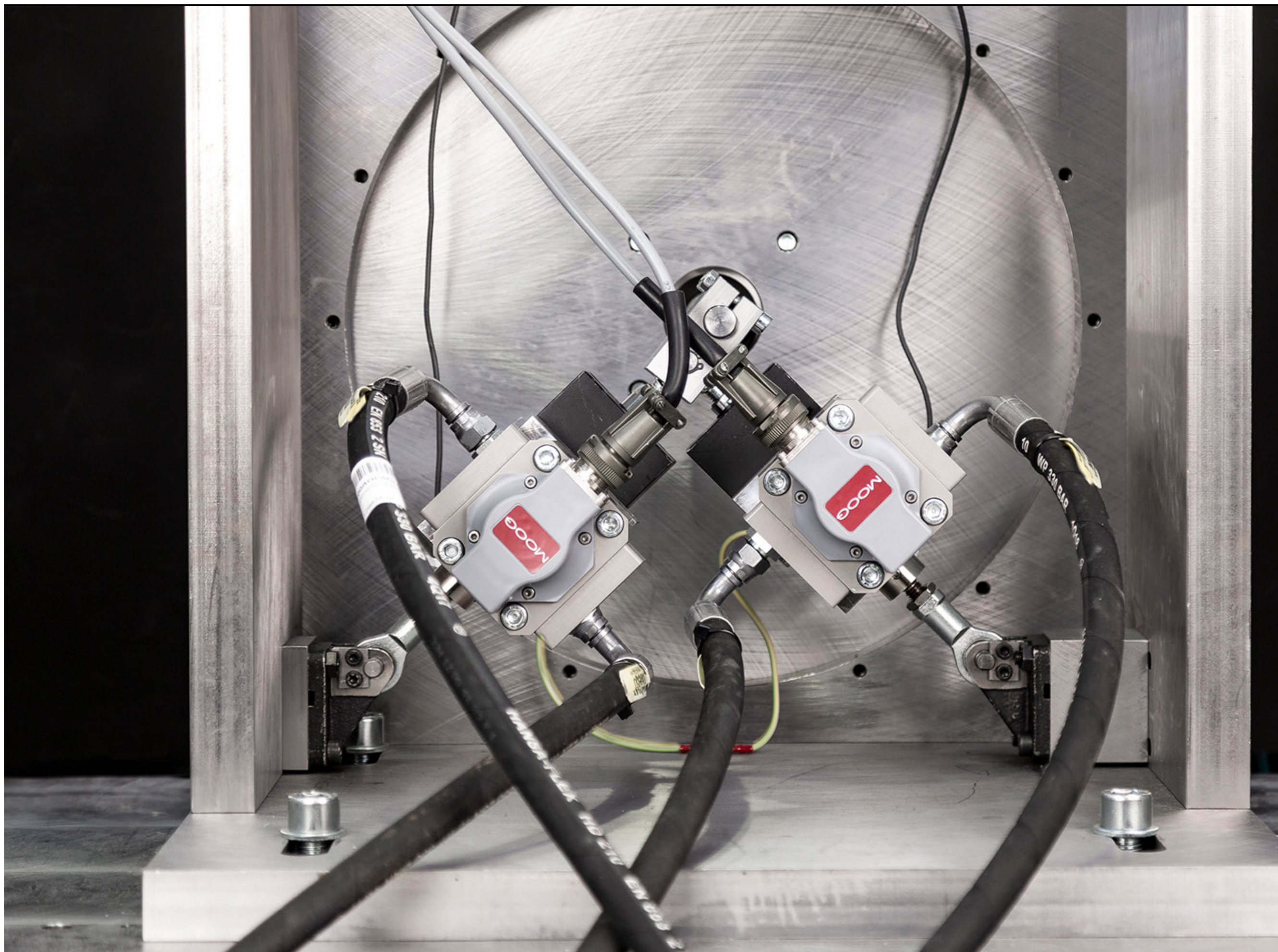
Prüfstand zur Untersuchung des Schlupfverhaltens der Werk- zeug-Spannfutter-Schnittstelle im Rahmen des AK Tools IV
